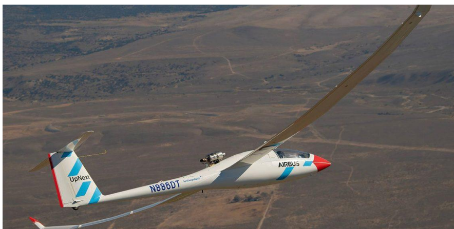
El Blue Condor de Airbus impulsado por combustión de hidrógeno
