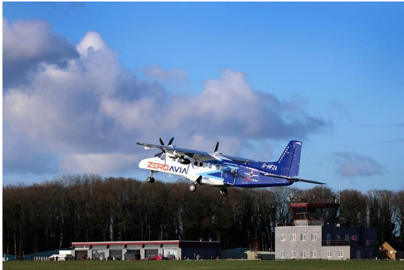
Dornier Do228 de ZeroAvia propulsado por pilas de combustible
