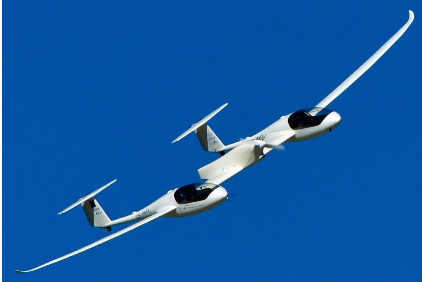
Prototipo HY4 de H2FLY propulsado por pilas de combustible 129
