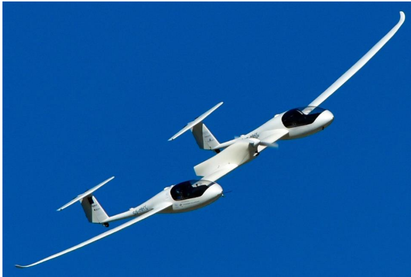
Fig 27. Prototipo HY4 de H2FLY propulsado por pilas de combustible 129
