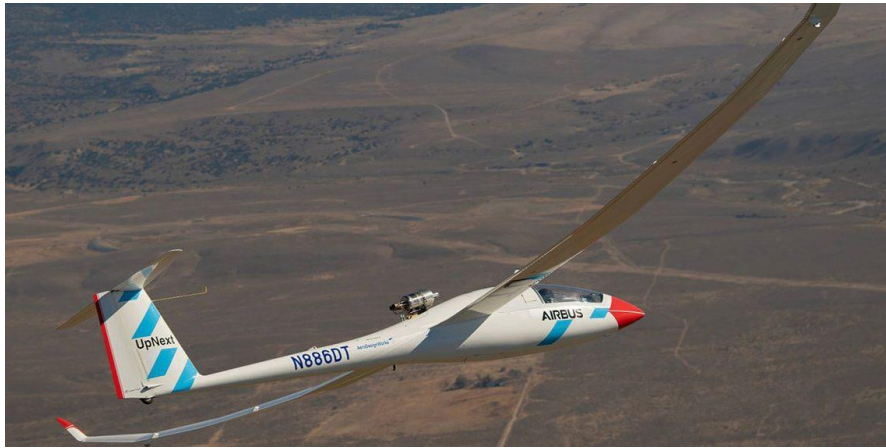
Fig 28. El Blue Condor de Airbus impulsado por combustión de hidrógeno
