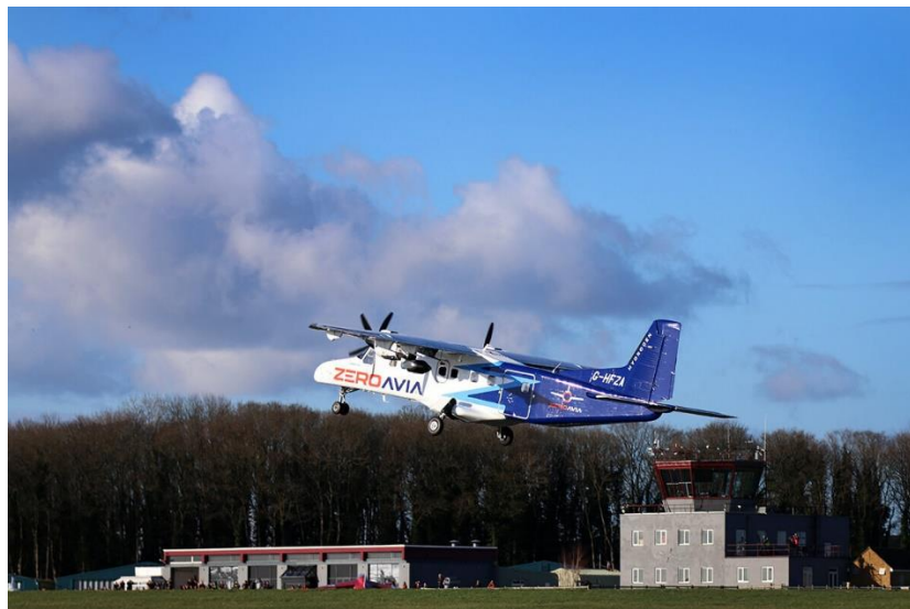
Fig 25. Dornier Do228 de ZeroAvia propulsado por pilas de combustible
