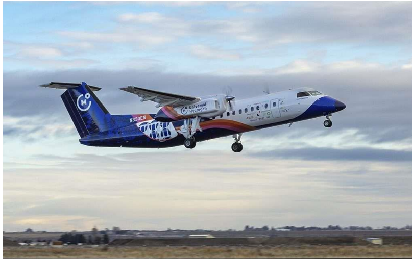
Fig 26. ATR-72 de Universal Hydrogen modificado para volar con pilas de combustible
