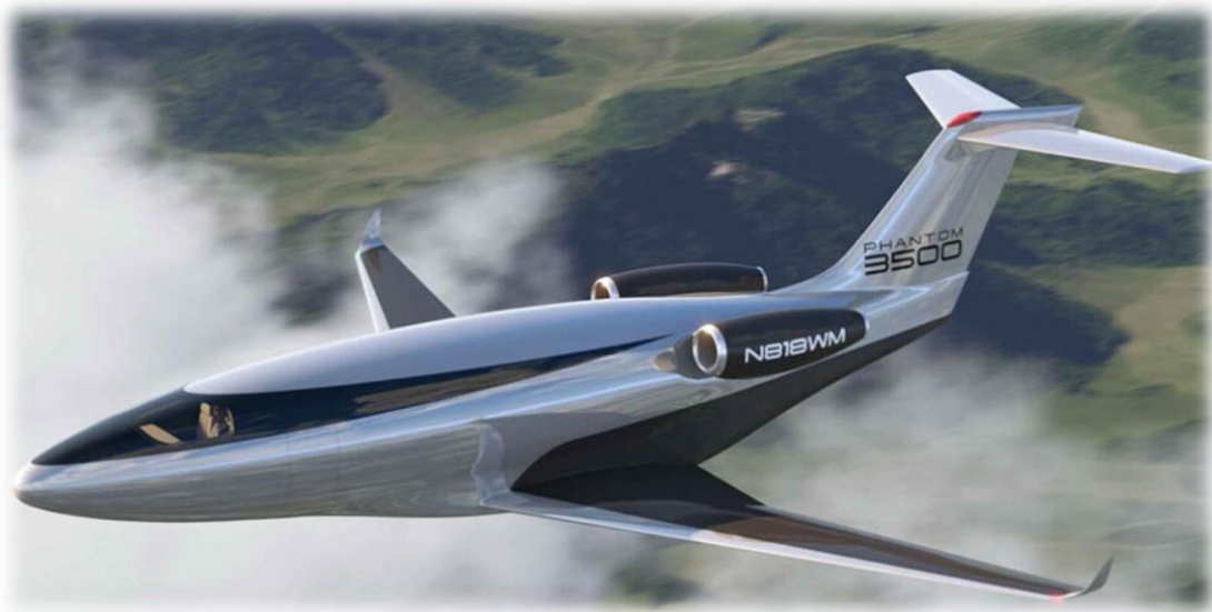
Ilustración 20. Modelo Phantom 3500 de Otto Aviation, sin ventanas para mantener flujo laminar (Fuente: Fly-news)
