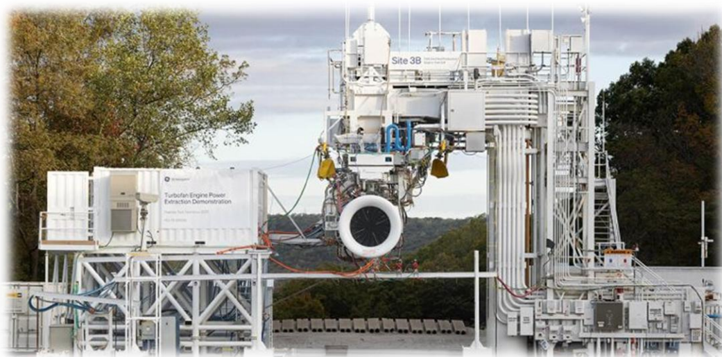
Ilustración 28. Banco de pruebas en tierra de un sistema propulsor híbrido-eléctrico de GE (Fuente General Electric)
