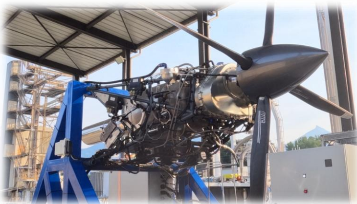
Ilustración 31. Ensayos en tierra de un motor turbohélice alimentado por H 2 (Fuente: BeautyFuel)
