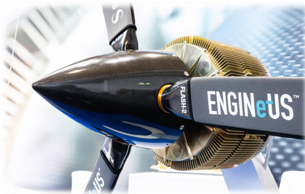
Ilustración 26. Propulsor eléctrico de aviación ENGINEUS de SAFRAN (Fuente SAFRAN)
