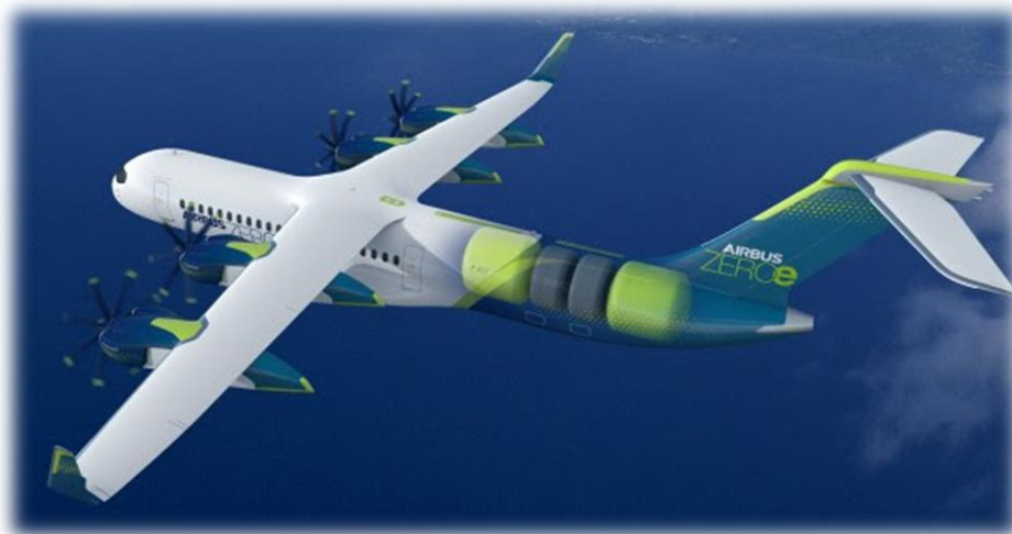
Ilustración 29. Diseño con pilas de H 2 del programa ZEROe de Airbus (Fuente Airbus)
