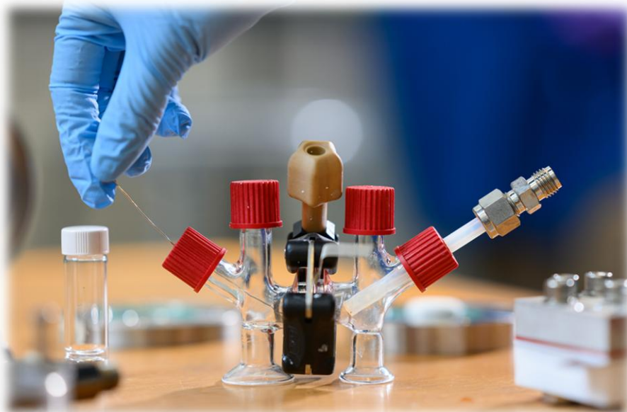
Ilustración 25. Ensayo de sistema eléctrico sodio-aire para la creación de corriente eléctrica (Fuente MIT)
